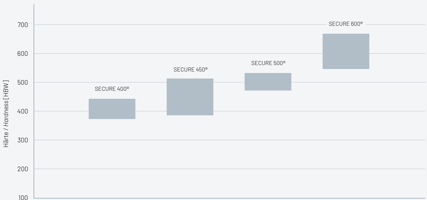
Abb./fig. 1 Härte der Sicherheitsstähle SECURE / Hardness of SECURE ballistic steels
